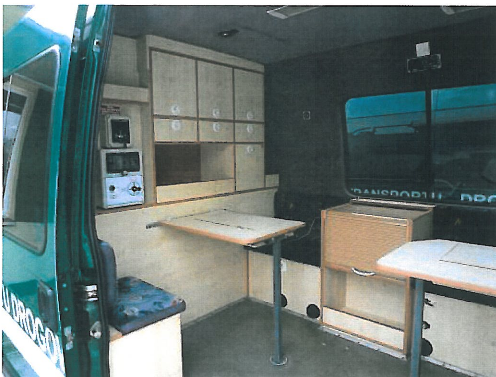
Fot. nr 4. Fragment przedziału zaadaptowanego na biuro dla Inspektorów (zabudowa meblowa na wyposażeniu)
