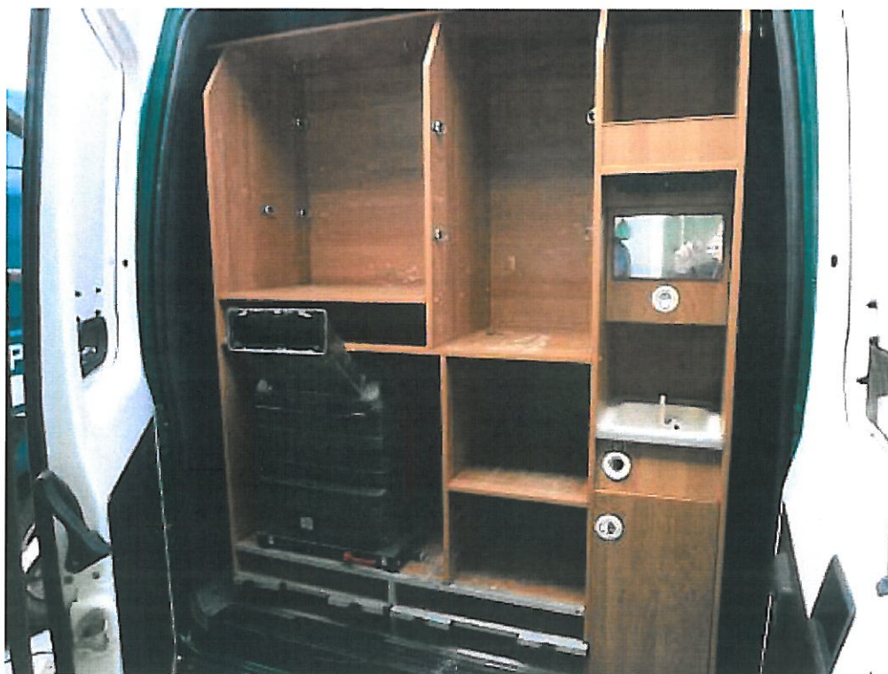
Fot. nr 6. Widok przedziału socjalnego w samochodzie ciężarowym Fiat Ducato wraz z agregatem prądotwórczym Honda EU 30.
