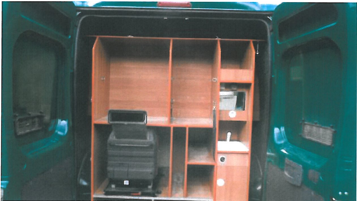
Fot. nr 6. Widok przedziału socjalnego w samochodzie specjalnym Fiat Ducato wraz z agregatem prądowórczym.
